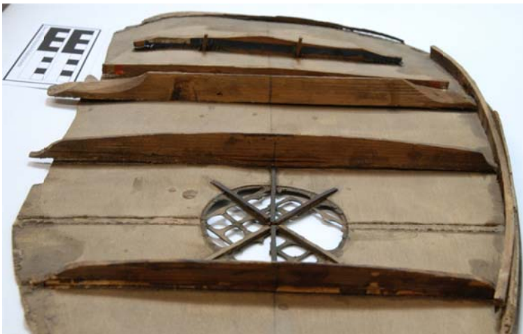
ABBILDUNG 83 DECKE MIT BALKEN - ANSICHT AUS HALSRICHTUNG H529
